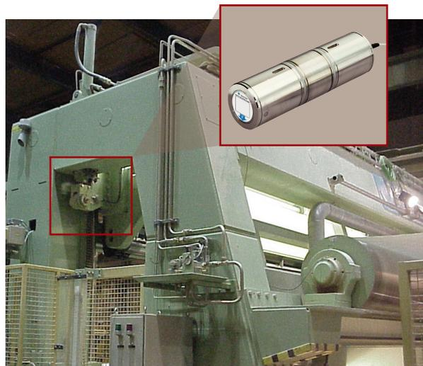
Тензодатчики, установленные в цилиндрах
