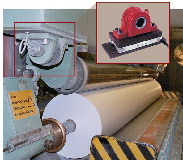
Тензодатчики, установленные под прижимным валом
