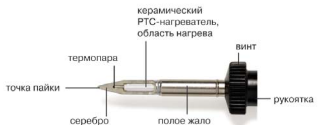
Рис. 8. Паяльное жало ERSA 612 в разрезе
