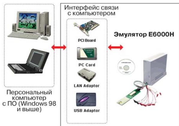
**Рис. 1. Пример программно-аппаратного комплекса разработчика, включающего полноскоростной эмулятор**
