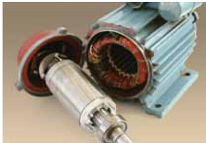
Ротор и статор асинхронного двигателя.
