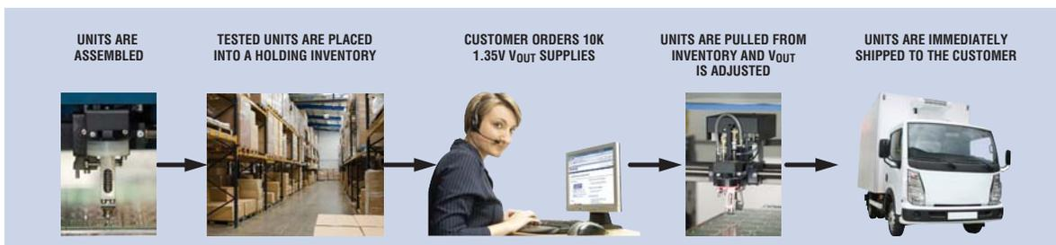
Рис. 2. Иллюстрация преимуществ использования источников опорного напряжения E<sup>2</sup>CRef при производстве изделий.
