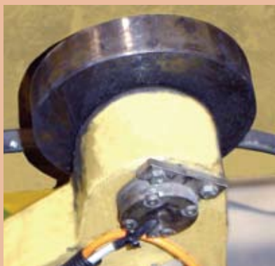
Тензодатчик вторичного рычага устанавливается непосредственно на втулке рулона.
