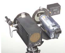
LF/Z-2 зеркальный полярископ – работает с рук или со штатива
