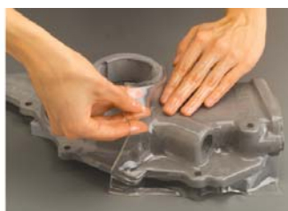
Нанесение покрытия PhotoStress®
