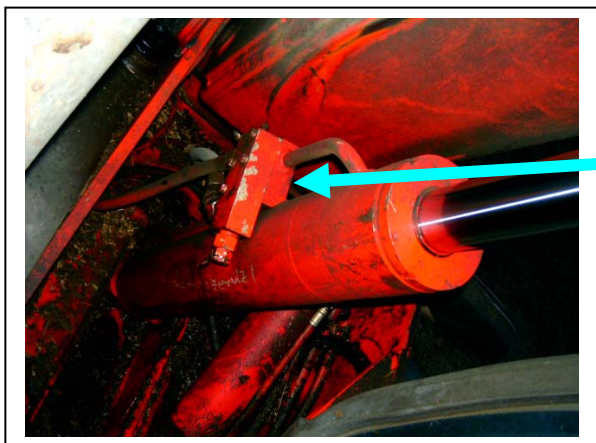
Рис. 1: Установка блокирующего клапана на цилиндр
