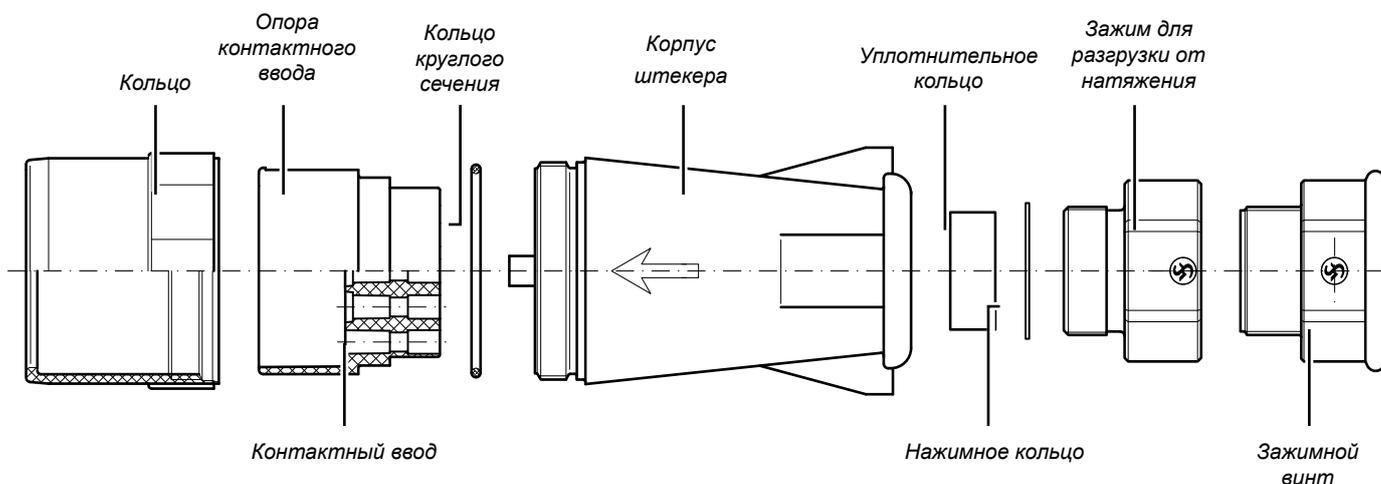
Контакты должны защелкнуться в контактной вставке со звуком. При монтаже или демонтаже зажима для нагрузки от растяжения зажимной винт должен быть полностью отсоединен от данного устройства.
