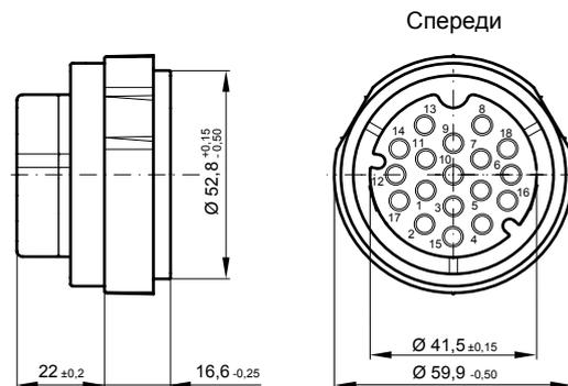
**UIC E-22P+PE, UIC E-22S+PE** Контактная вставка, не соответствующая норме UIC 558 Контактные вставки
