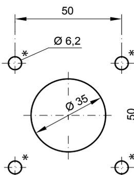
\* Диаметр для всех крепежных либо предохранительных элементов, например, головки винтов, макс. 12,5 мм.
