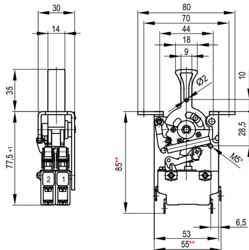
Специальное исполнение FL со сквозными отверстиями для крепления распорными винтами Ø5,5 (см. также код для заказа на стр. 3)
