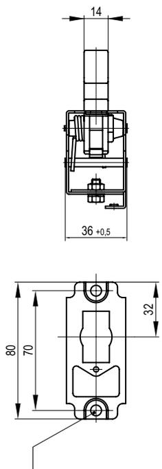
Крепление: стопорная гайка заклепочного типа M5 или специальное исполнение SO для крепления распорными винтами через сквозные отверстия Ø6,3.
