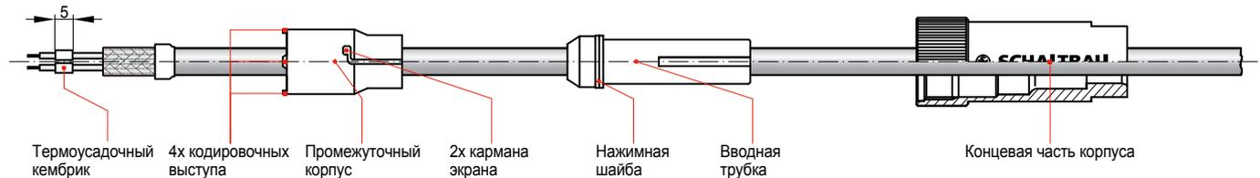
④ Надеть концевую часть корпуса, вводную трубку с нажимной шайбой и промежуточный корпус на кабель. Надеть термоусадочный кембрик (например, сверхгибкий термоусадочный кембрик 1/16SDSq) на отдельный провод.
