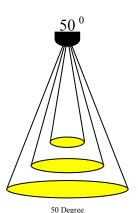
Light Dimansion Parameters  $1m/\emptyset$ : 0,94 m  $2m\,/\,\text{Ø}$  : 1,88 m3m /  $\emptyset$  : 2,82 m
