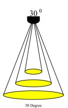
Light Dimansion Parameters  $1m / \emptyset : 0,53 m$  $2m / \emptyset$ : 1,06 m 3m/Ø: 1,59 m
