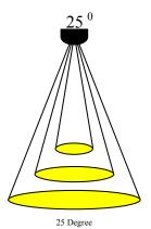
Light Dimansion Parameters  $1m/\varnothing$  : 0,44 m  $2m / \emptyset$  : 0,88 m  $3m / \emptyset$ : 1,32 m
