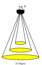
Light Dimansion Parameters  $1m/\varnothing$  : 0,44 m  $2m / \emptyset$  : 0,88 m  $3m / \emptyset$ : 1,32 m
