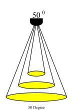
Light Dimansion Parameters  $1 \, \text{m} / \emptyset : 0.94 \, \text{m}$ 2m/Ø: 1,88 m  $3m / \emptyset$ : 2,82 m
